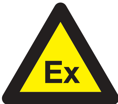
Fig. 8 Segnale di avvertimento per indicare le aree in cui possono formarsi atmosfere esplosive, ai sensi della norma "Atex"
