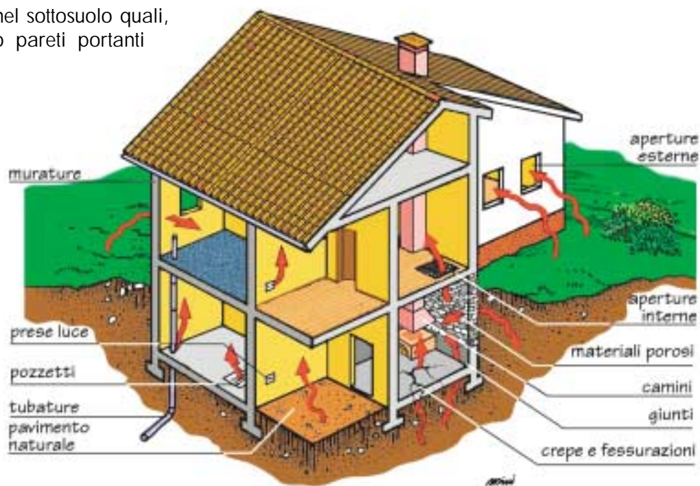
Fig. 3 - Punti d'infiltrazione del radon nell'edificio
