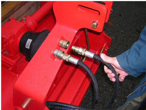
Esempio di supporto tubi idraulici
