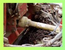
L'albero cardanico (causa di infortuni, anche mortali) deve essere protetto tramite idonea custodia non ruotante per evitare il rischio di afferramento e trascinamento.
