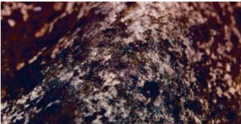
*Particolare di una lastra (tipiche le fibre di crocidolite di colore blu metallico).*
