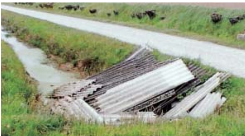
FOTO 8 – Esempio di grave incuria ambientale. Le lastre sono state abbandonate in vicinanza di un fosso. La differente colorazione in evidenza denota quali erano le facce esposte o sovrapposte. Tanto più la lastra appare scura, tanto più è datata.
