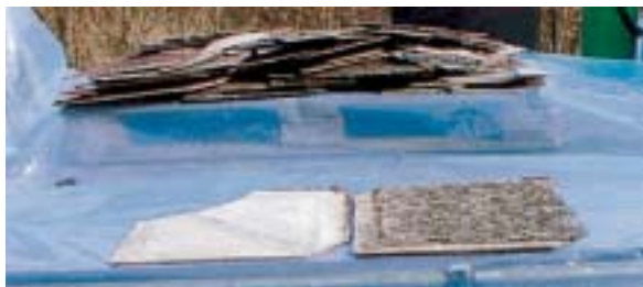
FOTO 6 Piastrelle da ricopertura in cemento amianto della grandezza di cm. 40 X 40; in evidenza la faccia non esposta e la faccia esposta agli agenti atmosferici.
