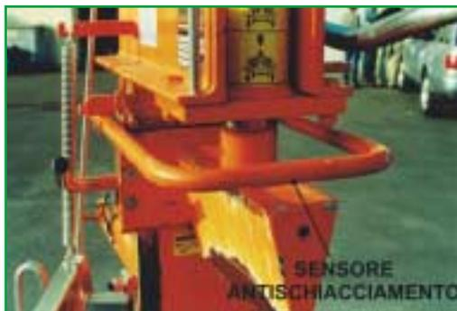
Fig. 8 - Sensore di sicurezza.
