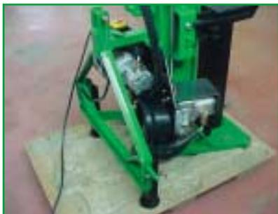
Fig. 5 - Spaccalegna predisposto per il funzionamento accoppiato ad una trattore con i punti di attacco ISO.
