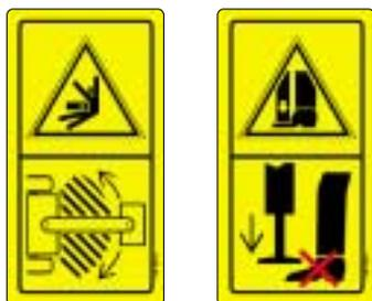
Fig. 9 - Esempio di pittogrammi richiamanti l'attenzione sui rischi connessi all'accoppiamento ed al disaccoppiamento della macchina alla trattrice.
