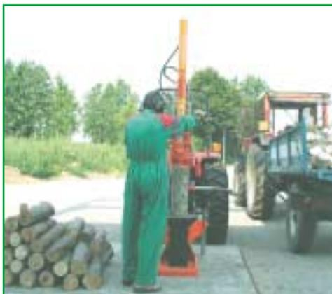
Fig. 10 - Esempio di cantiere di lavoro con spaccalegna.
