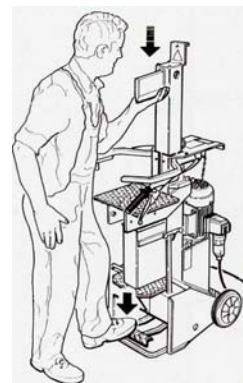
Dispositivo di sicurezza che blocca l'azione del cuneo in presenza di un ostacolo (es.: limitatore di pressione)
