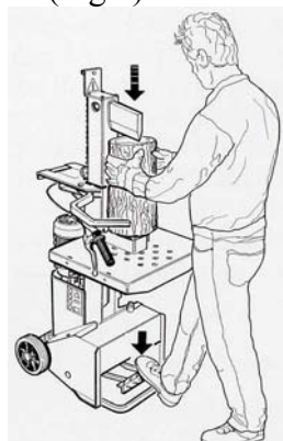
Fig.4 - Pedale che consente l'avvicinamento del cuneo verso il tronchetto Fig. 5 - Azionamento contemporaneo delle due leve di comando per iniziare il taglio
