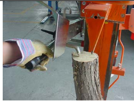
Leva di comando a uomo presente con dissuasore
