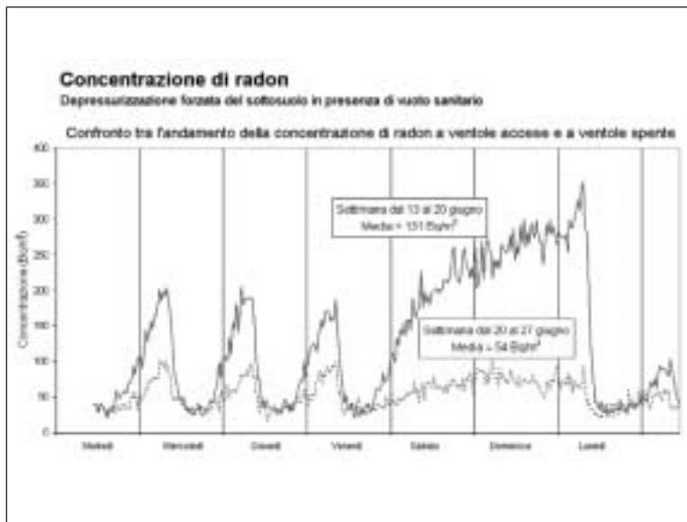
Fig. 50 Depressurizzazione forzata del sottosuolo in presenza di vuoto sanitario: andamento della concentrazione di radon presso l'asilo nido oggetto dell'intervento in presenza di ventole di aerazione accese e a ventole spente.
