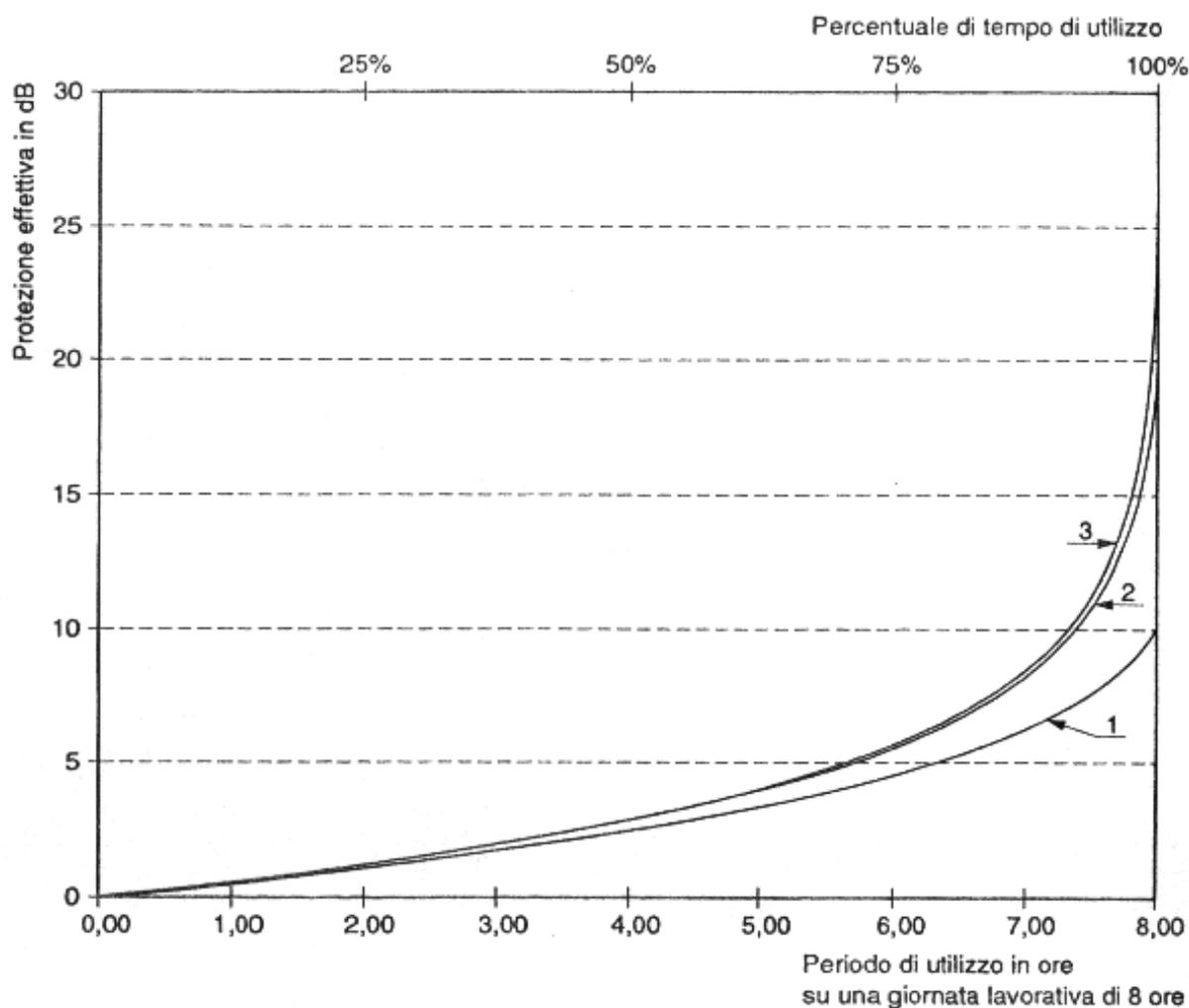
Curva 1 - otoprotettore che assicura un'attenuazione di 10 dB
