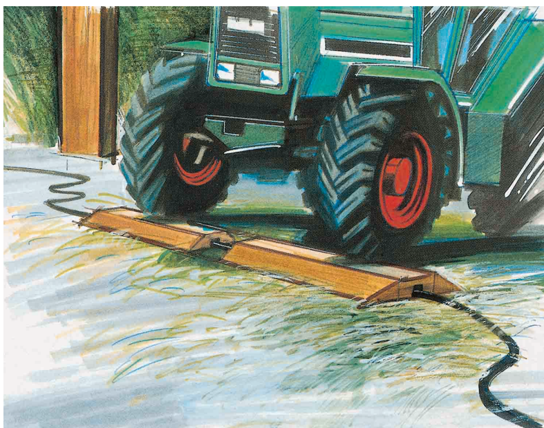
Fig. 7 - Corretta protezione del cavo elettrico
